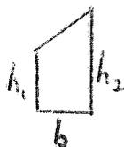
$$\text{Area} = \frac{b}{2}(h_1+h_2) \text{ or } \frac{1}{2}w(h_1+h_2)$$
